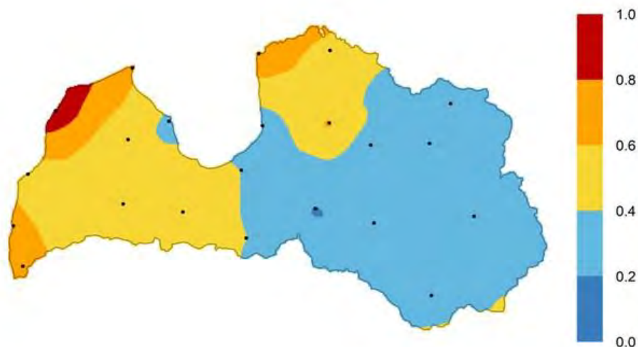
4.6. att. Modelis relatīvās jaudas koeficienta C_e^* telpiskajam sadalījumam “HAWT” tipa ģeneratoram ar nominālo jaudu 2,5 kW 10 m augstumā virs zemes.
