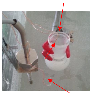
2.1. att. Eitektiskais maisījums konstantā temperatūrā ūdens vannā ar termopāriem.
