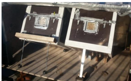
2.14. att. Eksperimenta izmēģinājuma kaste ar fasādes moduli pa kreisi un references sienas kaste bez fasādes moduļa (pa labi).
