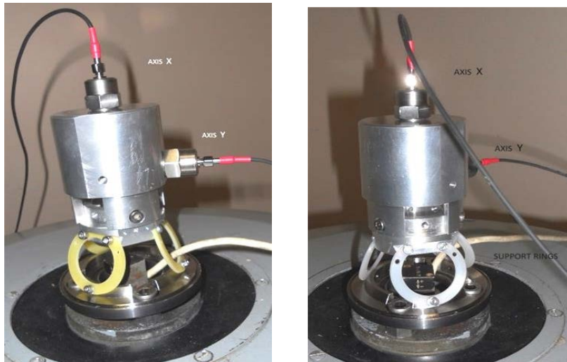
5.1. att. Akselerometru, kas mēra detektora imitatora vibropaātrinājumus uz gredzenveida balstiem no Composite G-Etronax (pa kreisi) un CESTILENE HD 1000 (pa labi) materiāliem, izvietojums.
