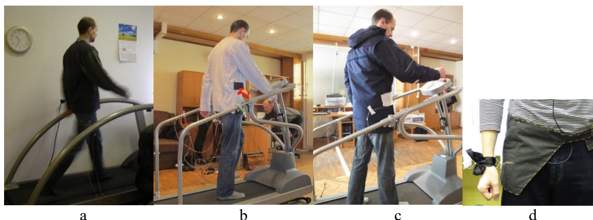
3.9. att. Elektromagnētiskā enerģijas pārveidotāja darbības testēšana: a – pirmās jakas makets; b – otrās jakas makets; c – virsjaka ar neaustu drānas siltinātāju; d – jostas soma un noņemama aprobe.
