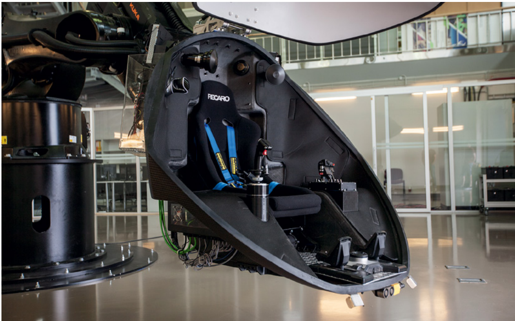
Robotizētais simulators – KUKA robots – Ziemeļeiropā patlaban vienīgā sistēma, ar kuras palīdzību iespējams veikt gan starpdisciplinārus pētījumus virtuālajā realitātē, medicīnā, kustības vadībā, gan arī nākotnē to varētu izmantot lidaparātu pilotu un sportistu treniņiem.
