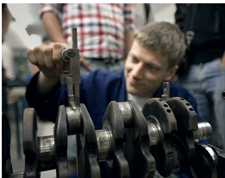
Studenti mēra kloķvārpstas parametrus Automobiļu remonta laboratorijā. Students measure the parameters of the crankshaft in the Car Repair Laboratory.
