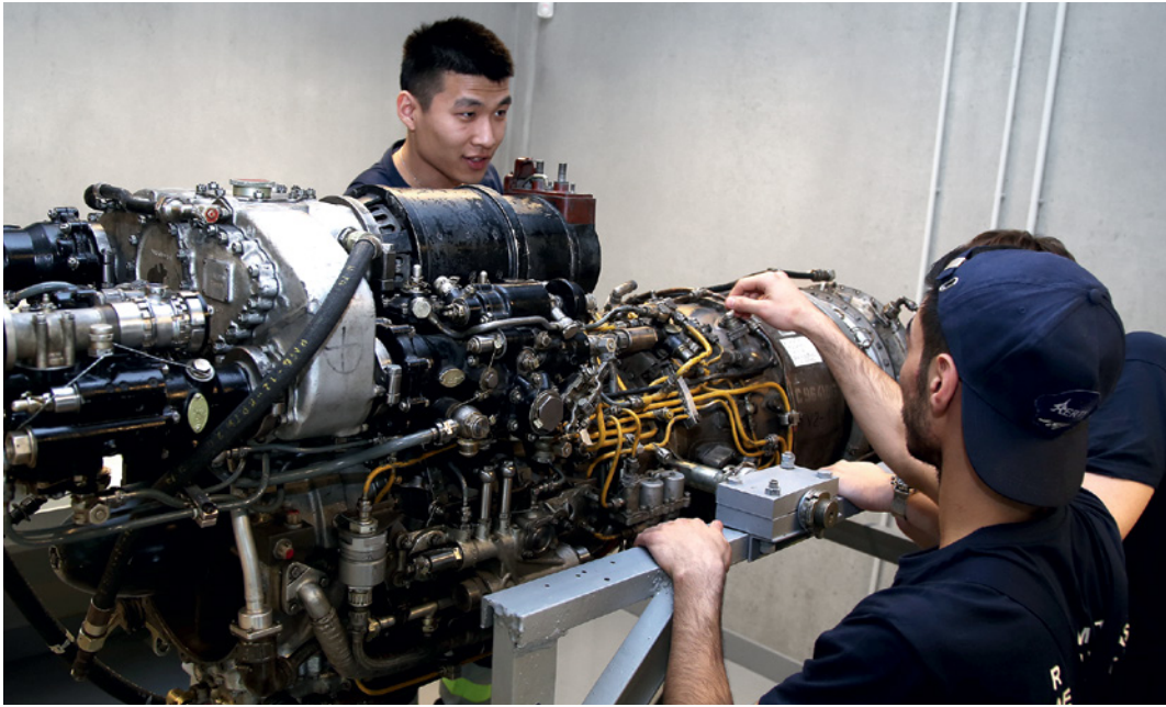
Aeronautikas institūta ārzemju studenti veic helikoptera Mi-2 gāzturbīnu dzinēja TV2-117 tehnisko apkopi institūta Gaisa kuģu dzinēju laboratorijā.
