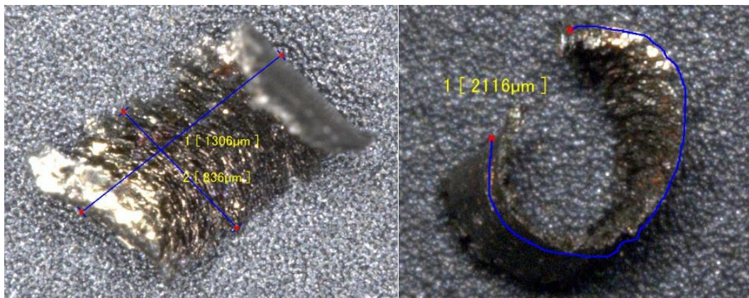
4.6. att. Skaidas morfoloģija, kur parādīts 836 µm platais skaidas segments, paredzamais garums 1306 µm un kopējais garums 2116 µm [21].
