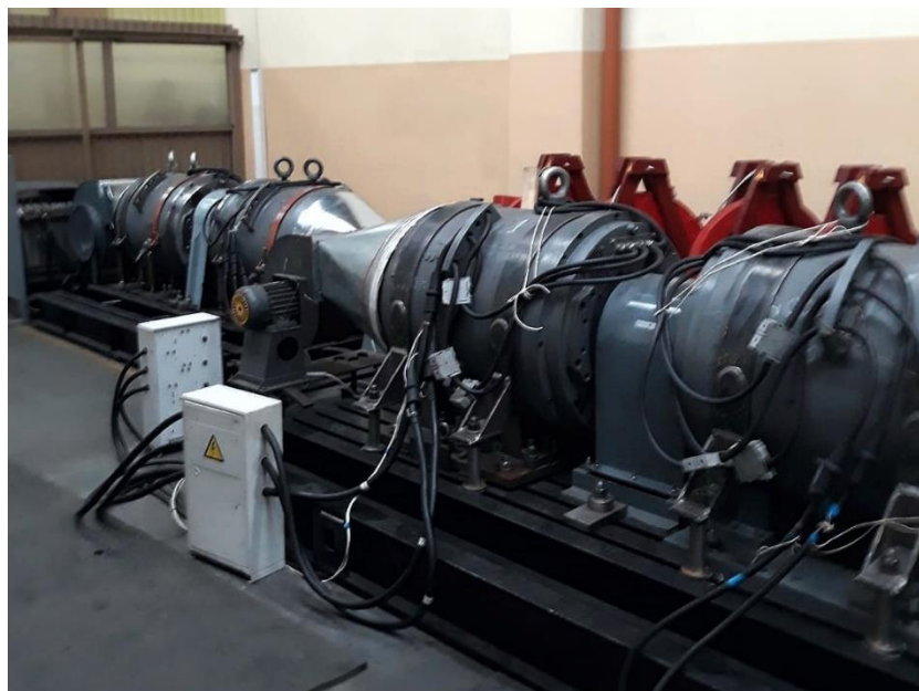
3.2. att. Divu AD – vilces dzinēja un ģeneratora režīmā –, kas savienoti ar cieto sakabi, darbības stendu fotogrāfija.
