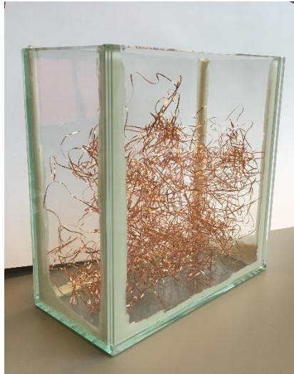
1.6. att. FMM trauks ar siltuma pārnese pastiprinātāja elementiem – smalkām vara stieplēm.
