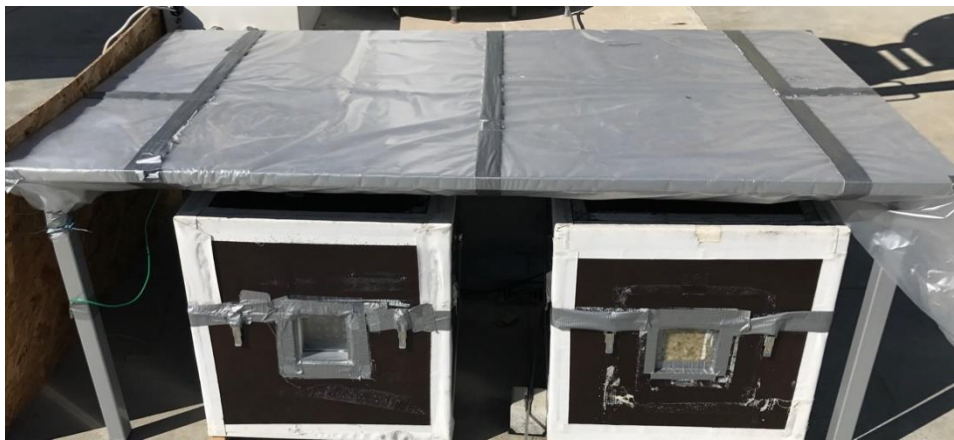
1.3. att. Eksperimentālā testa kaste ar fasādes moduli (pa kreisi) un references kasti bez fasādes moduļa (pa labi).
