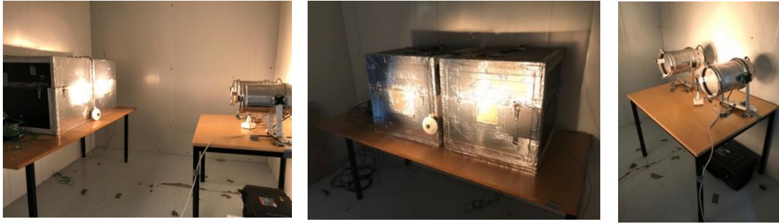
1.2. att. Eksperimenta elementu izvietoējums ar saules simulatoru un divām testa kastēm (atskaites siena – labajā pusē, siena ar testa moduli – kreisajā pusē).
