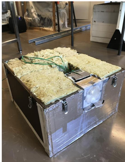
1.5. att. Fasādes modulis, kas iebūvēts eksperimentālajā testa kastē. Kopējā aprēķinātā saules fasādes moduļa U vērtība – 0,22 \text{ W}/(\text{m}^2\text{K}) , references sienai – 0,28 \text{ W}/(\text{m}^2\text{K}) .
