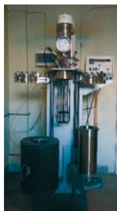
2.2. att. Autoklāva shēma (a) un Parr 4554 nerūsējošā tērauda autoklāvs (b)
