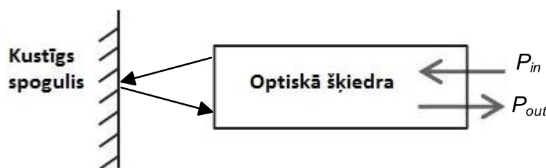
1.4. att. Vienkārša ārēja (angļu val. extrinsic ) intensitātes modulēta sensora uzbūve [104].
