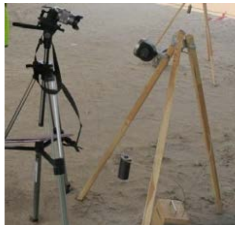
1.10. att. Attēlu apstrādes metode, izmantojot Maksimova tipa ielieču mērītāju.
