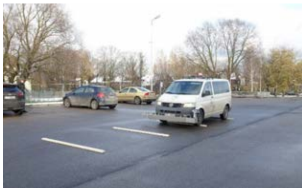
3.32. att. Ar lāzerprofilogrāfu aprīkots automobilis, pārbraucot, pārbraucot pār 4 cm augstiem dēļiem.
