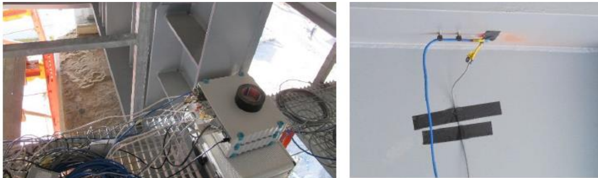
1.12. att. Piestiprināts tenzometrs (attēls pa labi) un SPIDER daudzkanālu sistēma, kurai piestiprināti tenzometri pirms pārbaudes ar dinamisku slodzi veikšanas.
