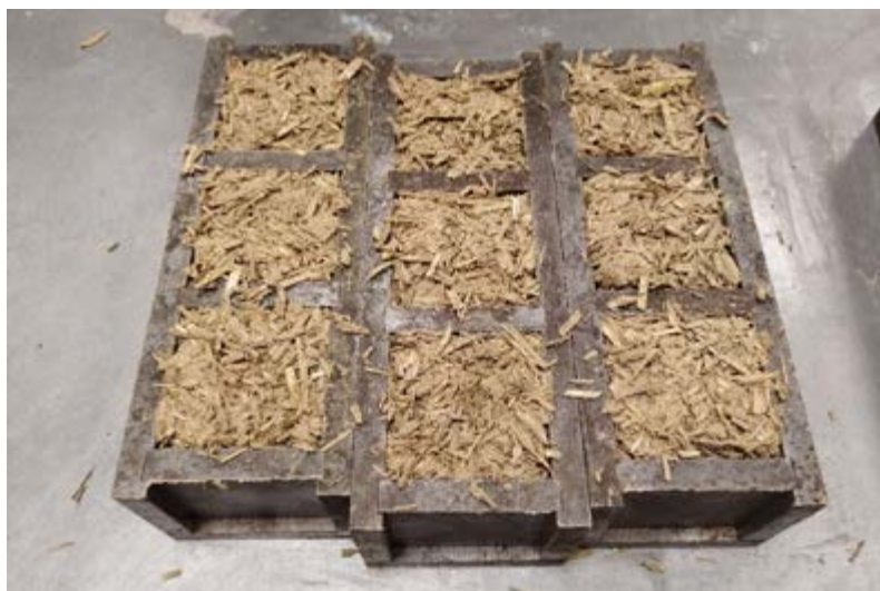
1. attēls. Biokompozītu izgatavošana tērauda veidņos.
