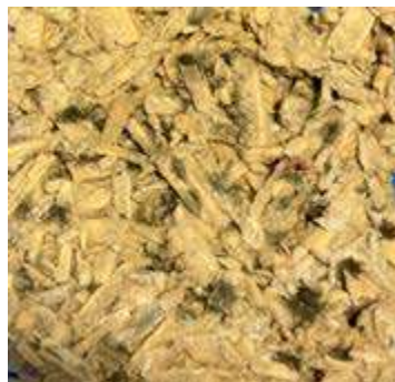
1. attēls. Ģipša-kaņepju spaļu biokompozītu struktūra: a) pēc ugunsreakcijas testa; b) pēc bioloģiskās noturības testa.
