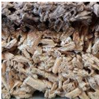
1. attēls. Ģipša-kaņepju spaļu biokompozītu struktūra: a) pēc ugunsreakcijas testa; b) pēc bioloģiskās noturības testa.
