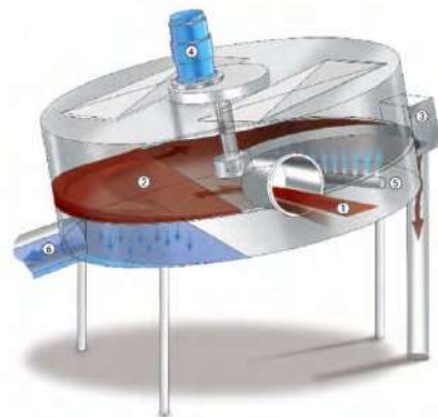
33. attēls. Notekūdeņu dūņu blīvētājs – slīpi novietots rotējošs siets 24
