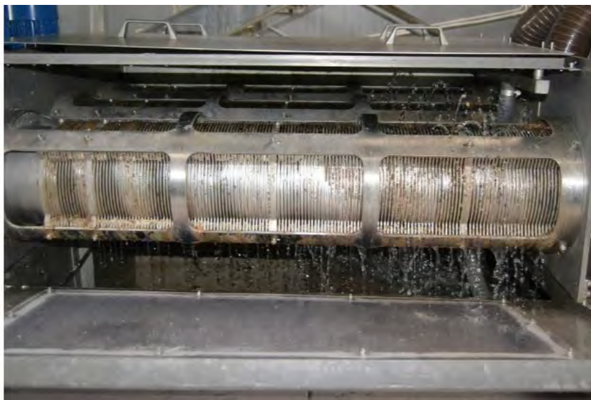
43. attēls. Disku preses darba zona atūdeņošanas procesa laikā 30
