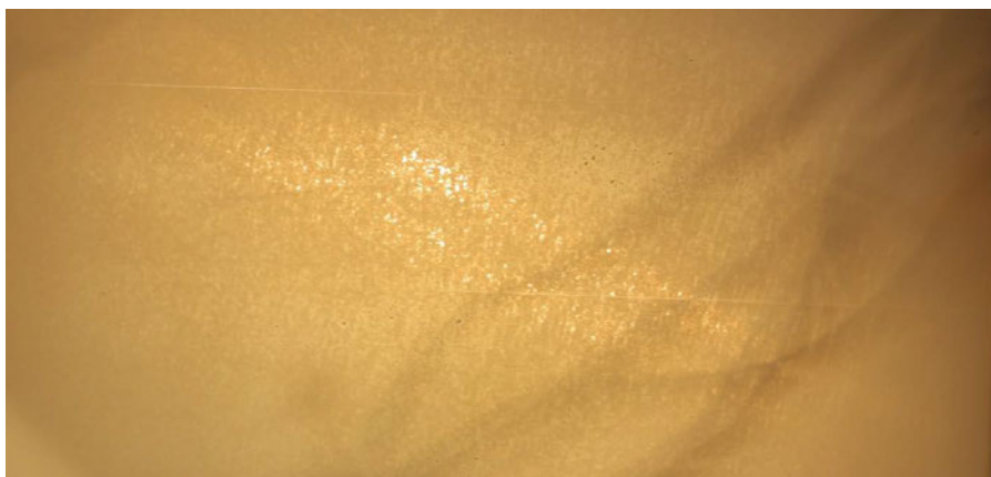
2.25. att. Bojāta SmA LC šūna ar nevienmērīgu aktīvo laukuma.
