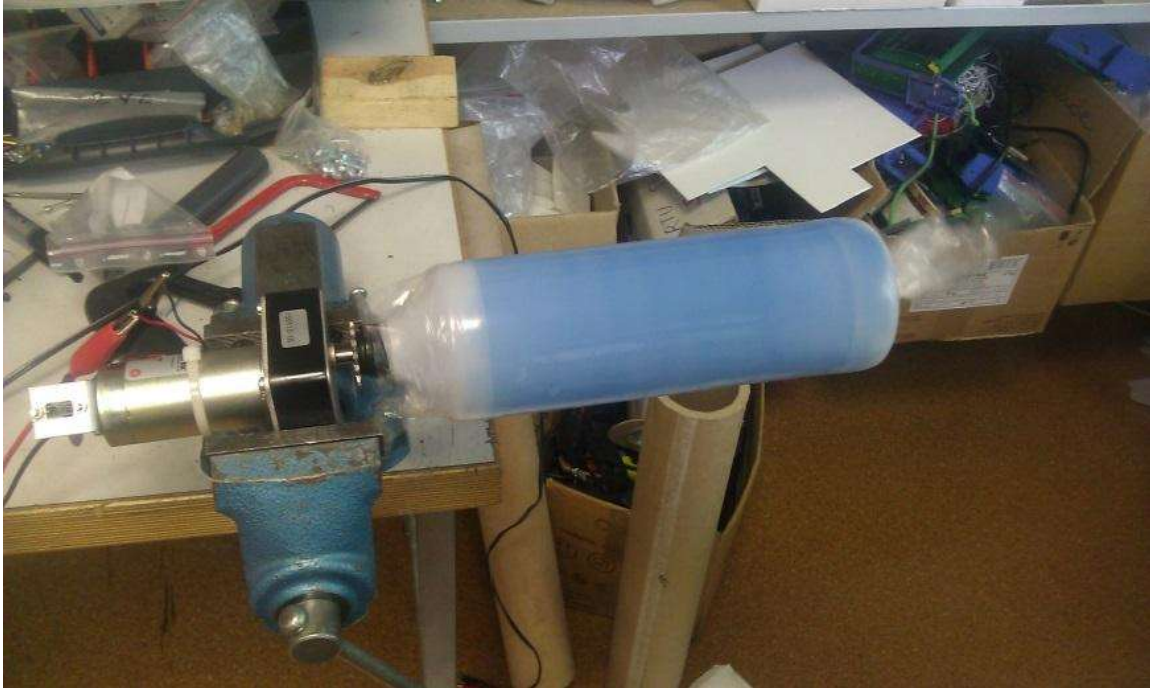
8.2. att. Uzklāts silikons (zilā krāsā) uz rotējošas virsmas.
