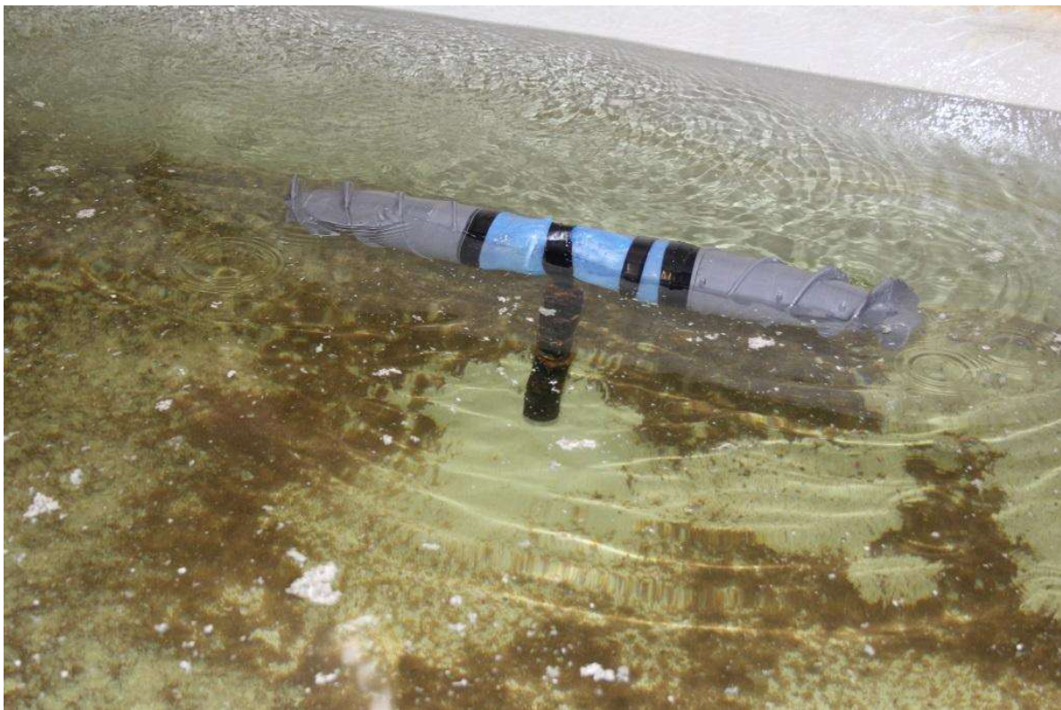
8.8. att. Durbis ielaists ūdenī ar papildus masu.
