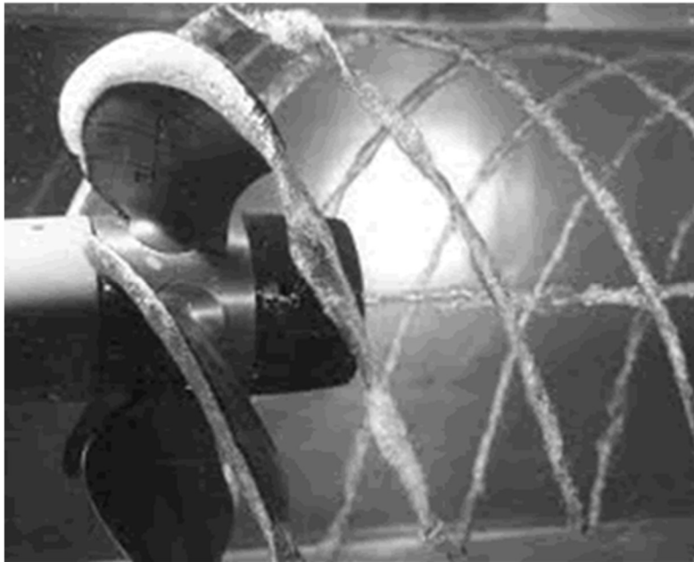
5.10. att. Dzenskrūves modelis ar kavitāciju ūdens tuneļa eksperimentā. [68]
