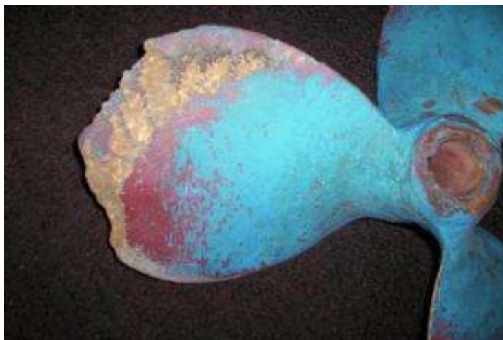
5.11. att. Kavitācijas rezultātā noēsta dzenskrūve. [64]
