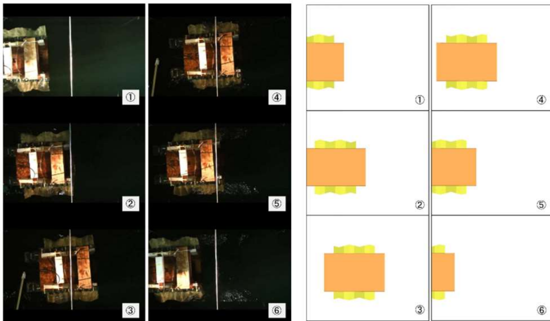
2.9. att. Robota spējas nobremzēt salīdzinājums ar matemātisko modeli (spuru frekvence 0.75 Hz). [12]
