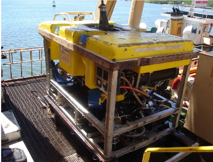
6.2. att. Tālvadāms zemūdens transportlīdzeklis Fugro G3 . [75]
