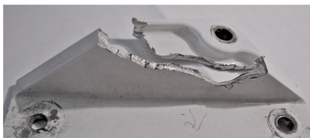
3. att. Gaisa kuģa "TECHAM" priekšējā riteņa šasijas balsta atloks.
