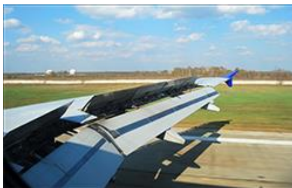
3.4. att. Lidmašīnas A320 nosēšanās. Izlaisti spoileri.
