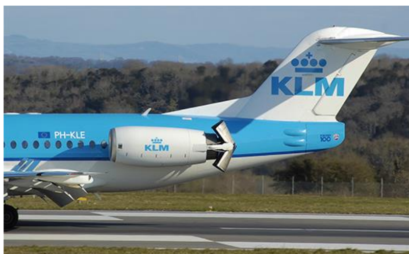
3.6. att. Reversēšana lidmašīnai Fokker F-100 kompānijā KLM.
