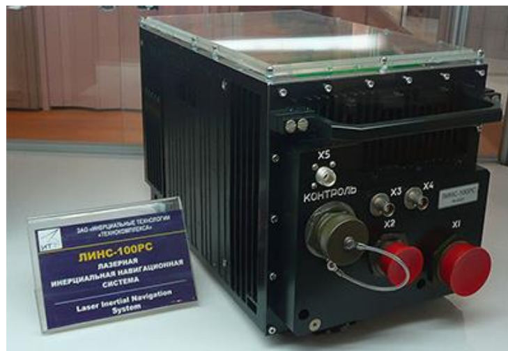
2.7. att. Inerciālā navigācijas sistēma LINS-100PC.
