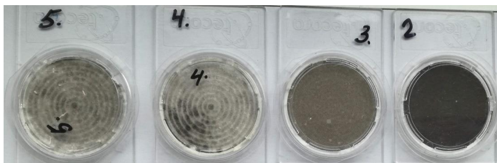
2.10. att. Filtri ar dažādām cieto daļiņu koncentrācijām.
