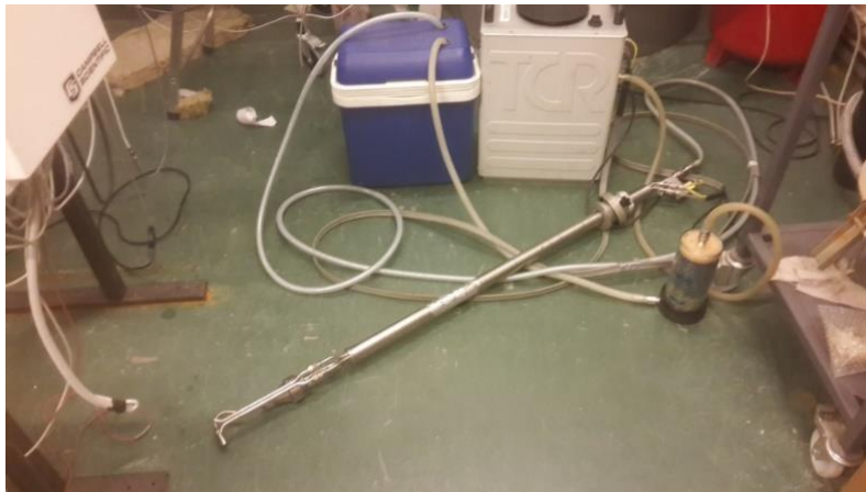
2.9. att. Cieto daļiņu mērīšanas iekārta Tecora Isostack G4 .
