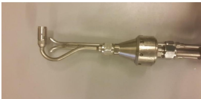
2.8. att. Cieto daļiņu mērīšanas iekārtas Tecora Isostack G4 zondes uzgalis.
