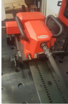
2.2. att. Metināšanas traktors Fronius® FlexTrack 45 Pro .
