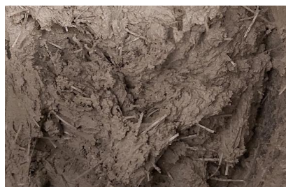
5.22. att. Sintētiskās makro šķiedras PP Strux 90/40: a) ārējais izskats; b) pievienošana betona sastāvam.
