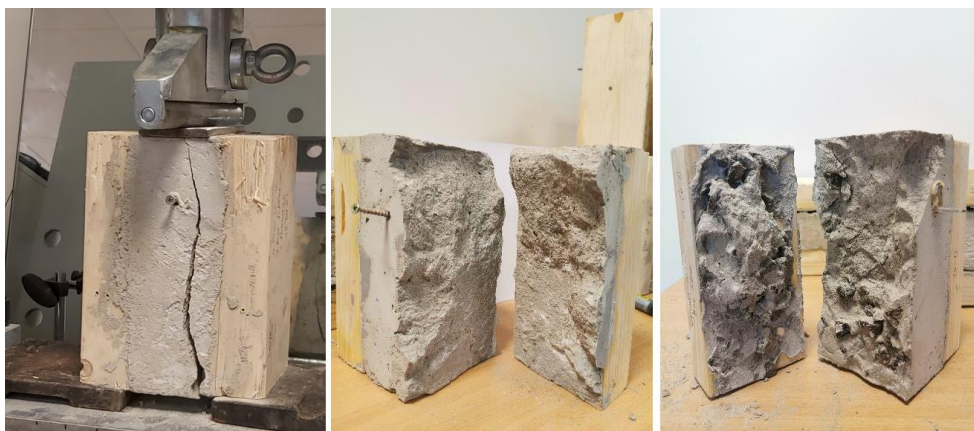
3.13. att. Paraugu sabrukumu ainas: a) plaisas attīstība paraugā pie sabrukuma; b) ar parasto līmes savienojumu; c) ar šķembām savienojumā.
