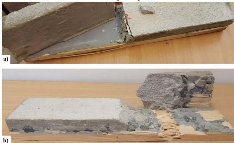
3.9. att. Mazgabarītu koka-betona paraugu sabrukuma ainas, kas bija ražoti pēc: a) sausās metodes; b) piedāvātās šķembu metodes.
