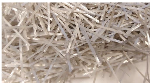
5.22. att. Sintētiskās makro šķiedras PP Strux 90/40: a) ārējais izskats; b) pievienošana betona sastāvam.
