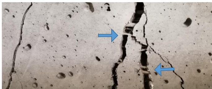
1.9. att. Tiltiņu veidošanās, betonā attīstoties plaisām.
