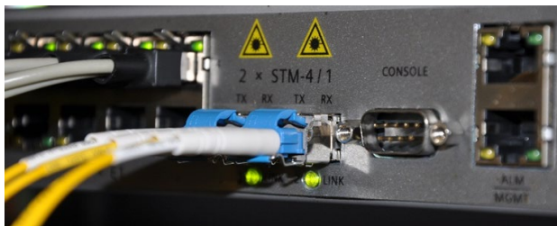
3.28. att. Optiskais multiplexors ar instalētiem SFP moduļiem.
