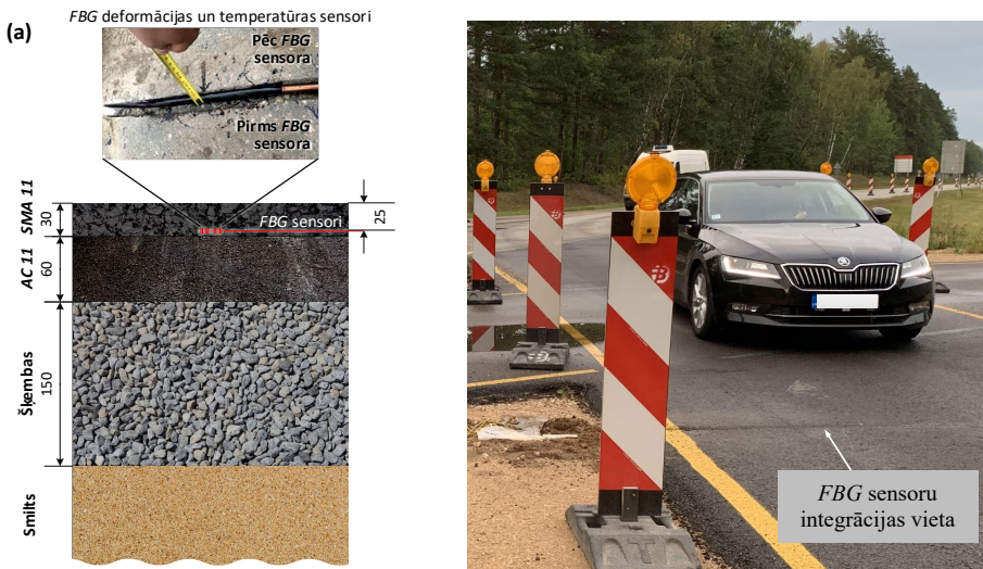
3.2. att. FBG sensora integrācija autoceļa seguma virskārtas slānī (a) un (b) lokācijā.
