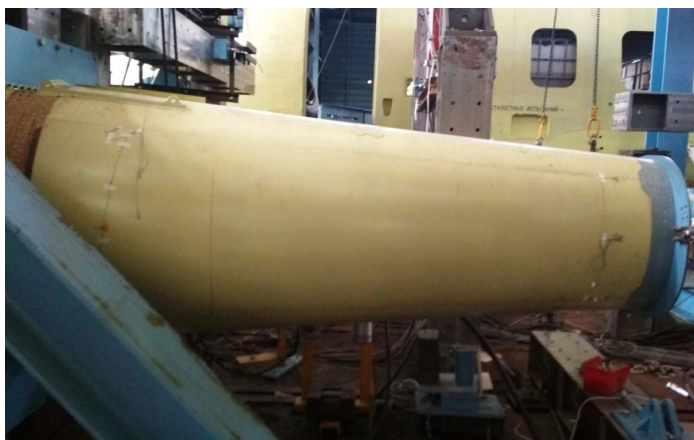
5.3. att. Helikoptera Ka-62 astes sija testēšanas iekārtā.
