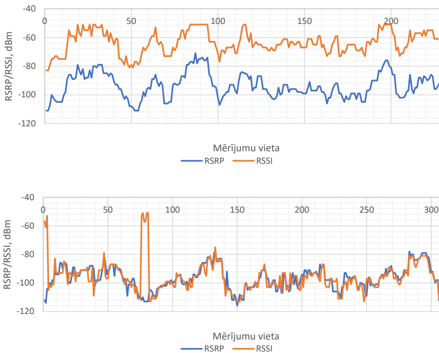
2.7. att. RSRP un RSSI mērijumu rezultāti, atkarībā no vietas ceļa posmā: augšējā grafikā – rezultāti mērijumiem 1. operatora tīklā; apakšējā grafikā – rezultāti mērijumiem 2. operatora tīklā.
