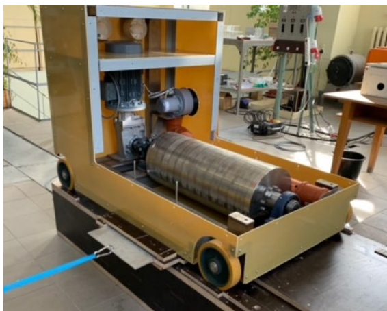
3.29. att. Foto no eksperimenta, kurā tiek nomērīts horizontālais spēks uz alumīnija loksni.
