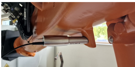
4.20. attēls. Trešās ass nulles pozīcijas iestatīšana ar EMD ierīci.
