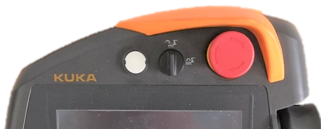
a) Režīmu pārslēgšanas atslēga un avārijapstures spiedpoga uz vadības pulsts.
