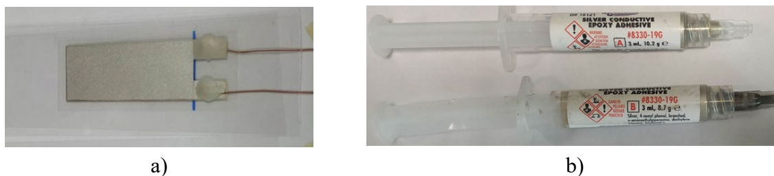
2.3. att. a) Pjezoplēves sensors ar pievienotiem vadiem; b) divkomponentu epoksīdsveķu līme.
