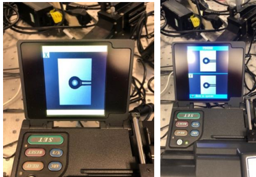
1.1. att. Bilde no RTU TI ŠOPS laboratorijas ar parametru pieskaņošanas procesu, kur (a) parāda gandrīz sfērisku mikrosfēru ar X diametru 324 \mu\text{m} un Y diametru 327 \mu\text{m} , bet (b) parāda gala rezultātu, kur iegūt ideāli sfēriska mikrosfēra ar X un Y diametru vienādu ar 350 \mu\text{m} .
