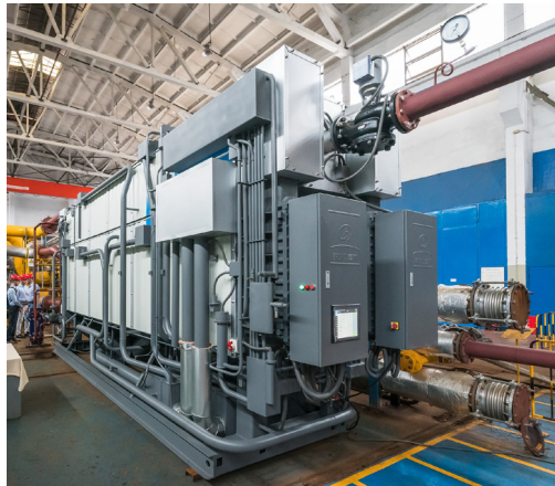
1. att. Absorbcijas tipa siltumsūkņa rūpnīcas testi (V. Žentiņa fotogrāfija).
