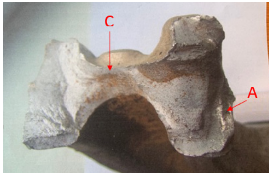
3. att. Sviras lūzuma virsmas attēls no pretējās puses, salīdzinot ar 2. attēlu.
