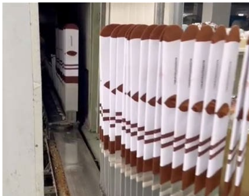
4.11. att. Zeķu izstrādājumu noslēdzošā hidrotermiskā apstrāde [36].
