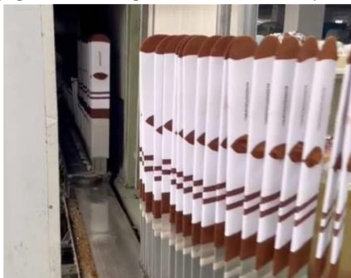
4.28. att. Zeķu izstrādājumu noslēdzošā hidrotermiskā apstrāde [131].
