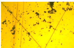
3.37. att. Bultskrūves 24. parauga metalogrāfiskā analīze, nobraukums 79 906 km.
