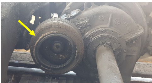
1.3. att. Gumijas korda sajūga slāņa sagraušanas piemērs.
