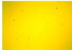
3.36. att. Bultskrūves 19. parauga metalogrāfiskā analīze, nobraukums 12 882 km.
