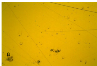
3.29. att. 10. parauga pētāmās bultskrūves mikrostruktūra, palielinājums: a – \times 50 ; b – \times 200 .
