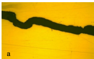
3.30. att. 11. parauga pētāmās bultskrūves mikrostruktūra, palielinājums a – \times 50 ; b – \times 200 .
