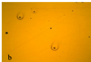
3.29. att. 10. parauga pētāmās bultskrūves mikrostruktūra, palielinājums: a – \times 50 ; b – \times 200 .
