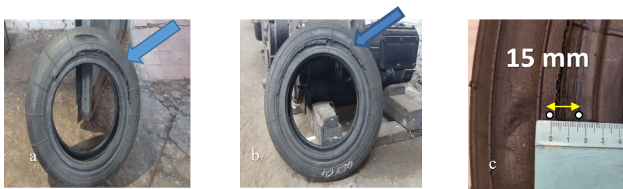
3.1. att. Gumijas korda sajūga sānu virsmas sagraušanas piemēri: a – 1. paraugs; b – 2. paraugs; c – sagraušanas zonas noteikšana.
