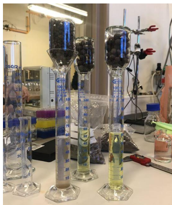
2.4. att. Filtrmateriāla ūdens aizturēšanas spēju testi.
