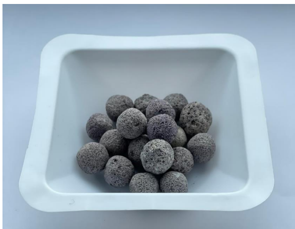
3.2. att. Vulkanizētu koksnes šķeldas pelnu materiāla lodītes, kas pagatavotas no homogēniem sijātiem pelniem 1220 °C.
