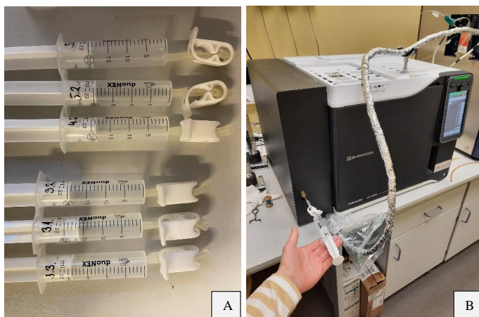
2.12. att. Gazu paraugu savākšana noslēgtās šļircēs (a) un paraugu testēšana gāzu hromatogrāfā Shimadzu Nexis GC-2030 (b).
