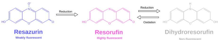
2.7. att. oksidēšanās-reducēšanās indikatora resazurīna reducēšanās [125].
