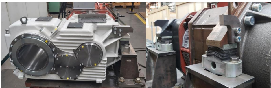
5.20. att. MRB izvietojums uz testa platformas, lai noteiktu tā pašvibrācijas.
