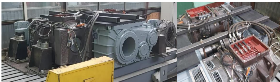
5.21. att. MRB izvietojums uz platformas savstarpējās noslodzes režīmā.
