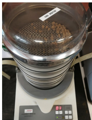
2.53. att. Ar sietu komplektu aprīkota iekārta Pulverisette ar AL apstrādāto putekļu frakcionēšanai.
