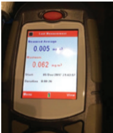
1.13. att. Iekārta putekļu daudzuma mērīšanai gaisā MICRODUST PRO™ .
