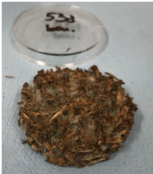
1.5. attēls. Micēlija paraugs, kas gatavots no Trichoderma viride , izmantojot tikai barotni.
