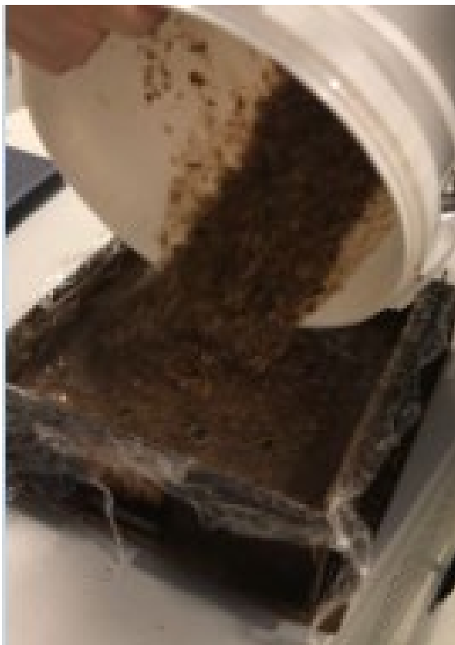
1.9. attēls. Micēlija materiāla ieliešana veidnē.
