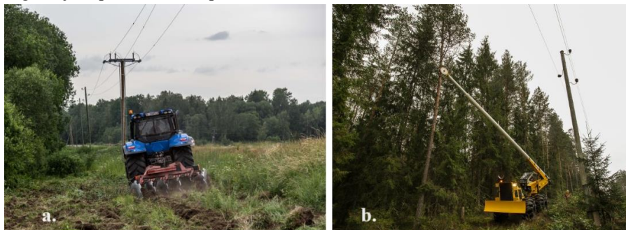
5.35. att. AS “Sadales tīkls” infrastruktūras veģetācijas tīrīšanas specializētā tehnika (a. horizontālā apauguma tīrīšanai; b. vertikālā apauguma tīrīšanai (koku zaru apzāģēšanai)).
