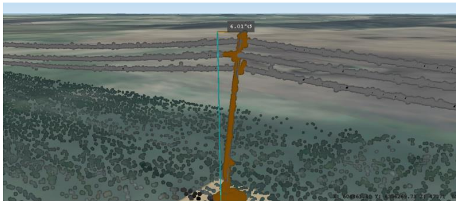
4.25.att. Infrastruktūras ģeotelpiska defekta noteikšanas piemērs.
