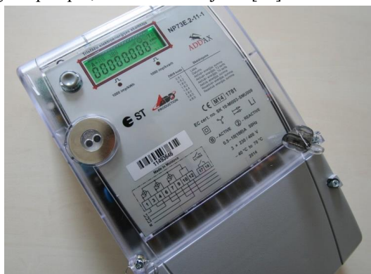
2.1. att. Elektroenerģijas uzskaites viedais skaitītājs (Latvija, 2024).
