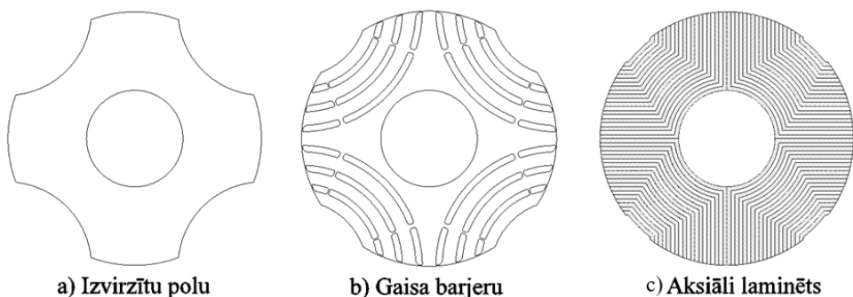
2.17. att. SynRM rotoru konstrukcijas: a) izvirzītu polu; b) nemagnētisku gaisa barjeru; c) aksiāli laminētas elektrotehniskā tērauda loksnes
