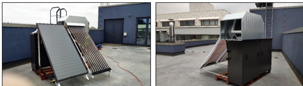
1.1. attēls. Saules kolektoru testēšanas stends (Bogdanovičs, 2021).
