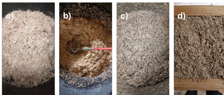
7.8. att. Biokompozītu izgatavošanas procedūra: a) PLW pildviela; b) pildvielas samitrināšana, samaisīšana; c) saistvielas iestrādāšana maisījumā; d) biokompozīta formēšana.
