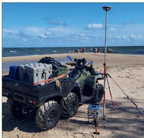
12.2. attēls. Gravimetra pārvadāšana, izmantojot augstas caurgājības tehniku un ražotāja transporta ietvaru.
