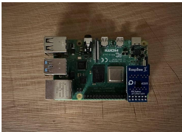
1.9. att. Raspberry Pi vienkāršdatora platforma ar pievienotu RaspBee II Zigbee vārtejas moduli bezvadu tīklu izveidei.
