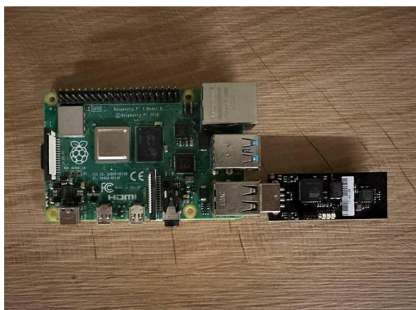
1.10 att. Raspberry Pi vienkāršdatora platforma ar RZUSBstick Zigbee adapteri bezvadu tīklu analīzei un datu pārsūtīšanai.
