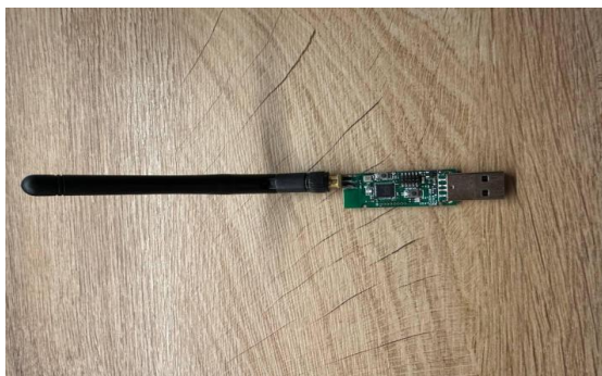
1.11. att. CC2531 USB Zigbee analizators ar pastiprinātu ārējo antenu bezvadu tīklu uzraudzībai.
