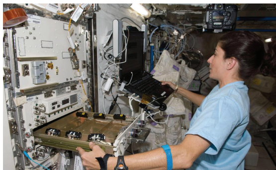
0-8. att. NASA inženiere Nikola Stota orbitālajā stacijā JSS darbā ar elektronisko mikroshēmu ražošanai nepieciešamo monokristālu audzēšanas iekārtu.
