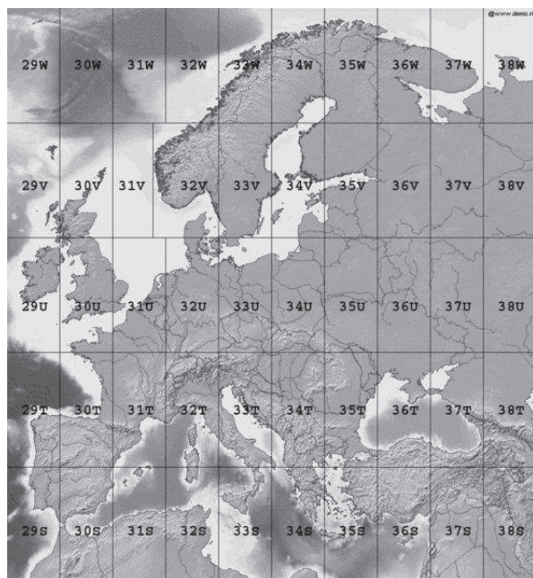
3-106. att. Merkatora transversās projekcijas karšu mozaika.
