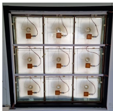
3.9. att. Testēšanas (pa kreisi) un references (pa labi) stendi (a); saules fasādes sistēma ar deviņiem mazizmēra dinamiskajiem moduļiem no ārpuses (b) un no testēšanas kabīnes iekšpuses (c).
