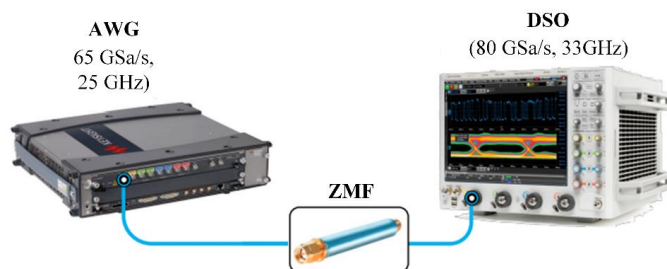
4.11. att. Mērījumu shēma, kas tika izmantota elektrisko impulsu paplašināšanas izpētei, izmantojot LPF
