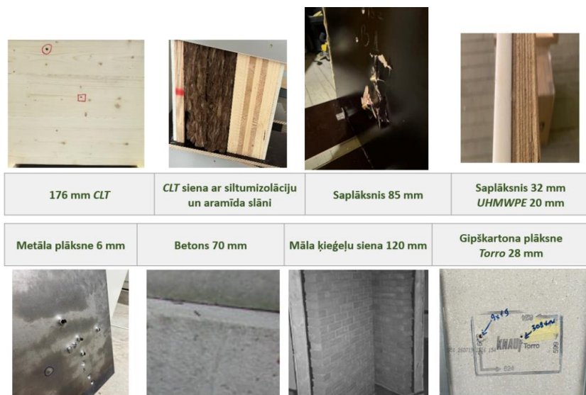
5.7. att. Astoņas aplūkotās ballistikās sienas. [9], [20], [37], [42],[44]
