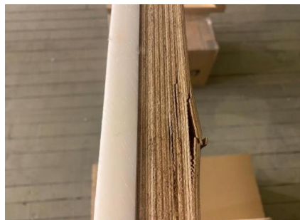
5.7. att. 1_1 paraugs. UHMWPE 20 mm – saplāksnis 32 mm sānskats.
