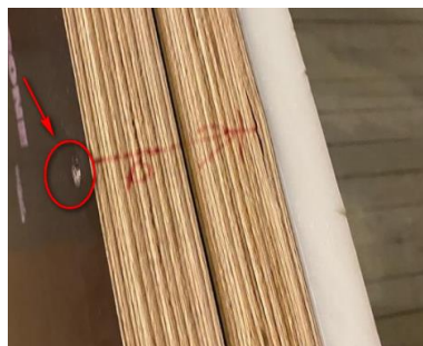
5.11. att. 2_2 paraugs. Saplākšnis 2x32 mm– UHMWPE 20 mm.
