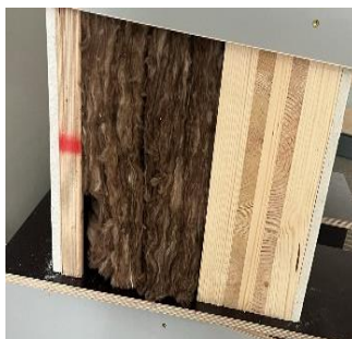
5.1. att. CLT sienas (A paraugs) kārtu shematisks attēlojums (skatīt kopā ar 5.1. tab.) un fotouzņēmums, sānskats (atzīme sarkanā krāsā ir koka rāmis ģipša plāksnes stiprināšanai).
