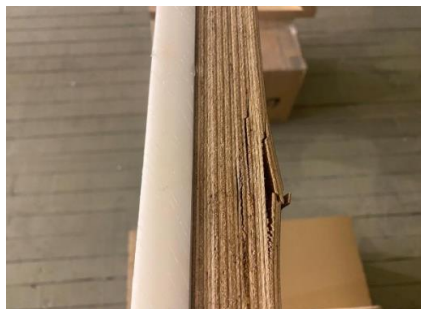
5.7. att. 1_1 paraugs. UHMWPE 20 mm – saplāksnis 32 mm sānskats.
